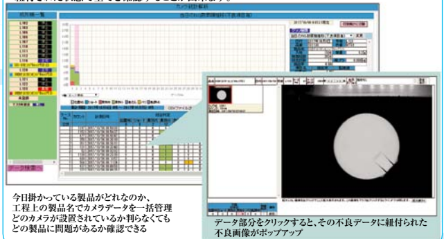
▲カメラデータ解析システムのGUI。データ部分をクリックすると不良データに紐づいた不良画像がポップアップ表示される
