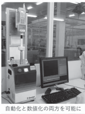
図表9 嵌合検査の強度測定とZ-gauge導入による数値
